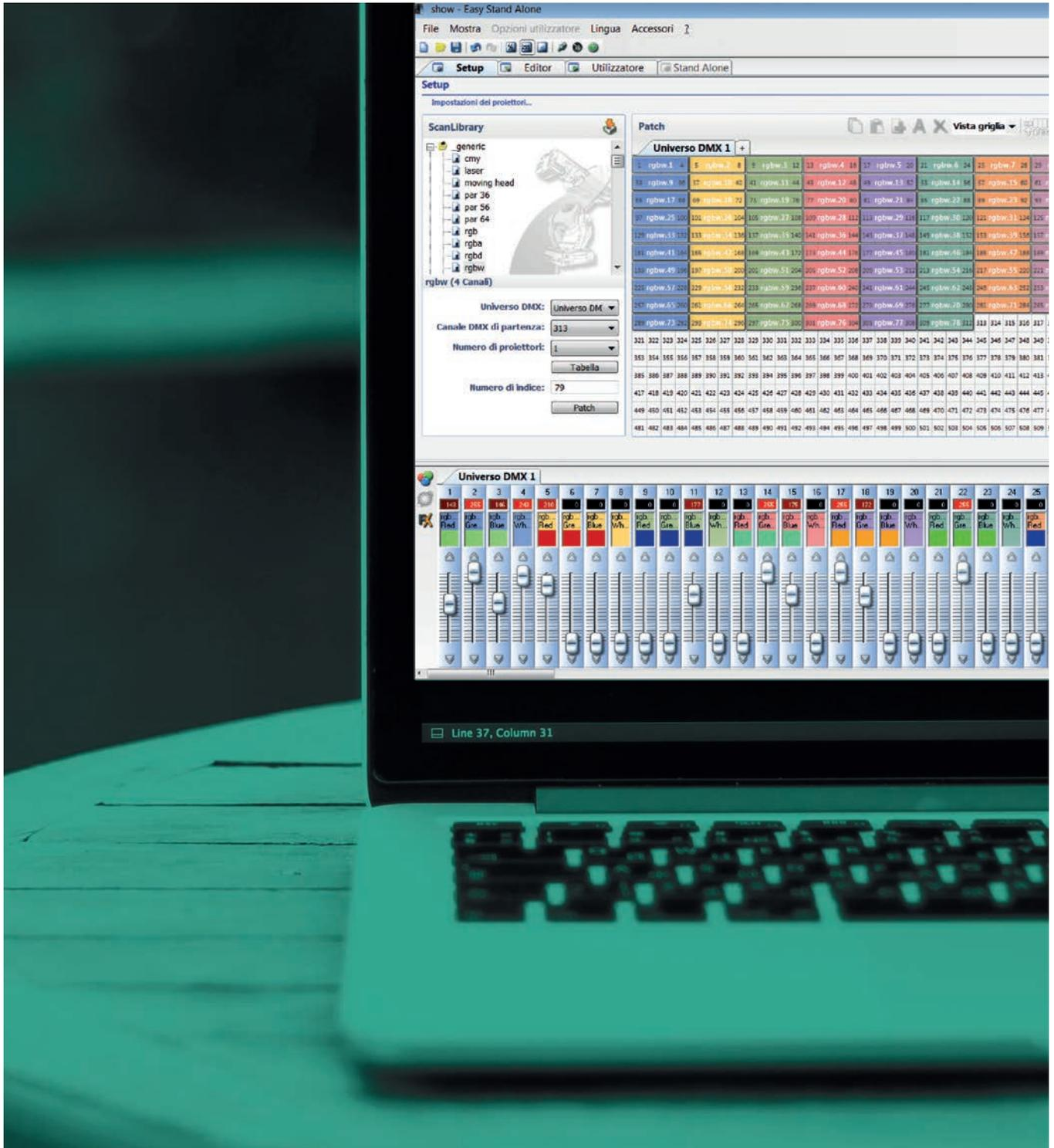
Die RGB- und RGBW-Leuchten verwenden für die Programmierung und Steuerung das digitale Protokoll DMX 512, den am weitesten verbreiteten und bestätigten Standard für die Steuerung intelligenter Beleuchtung. Dies ermöglicht die vollständige Kompatibilität mit anderen auf dem Markt verfügbaren Leuchten und eine große Vielzahl von preiswertem Zubehör.
